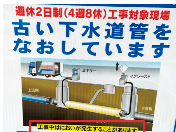
写真5 工事件名板による臭気発生に関するお知らせ状況
