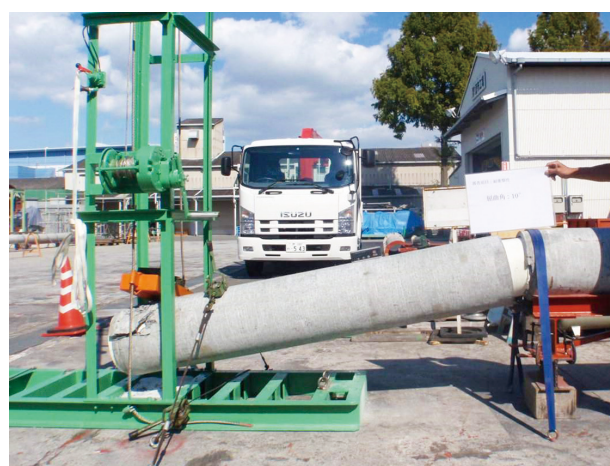
写真3 耐衝撃性試験状況
