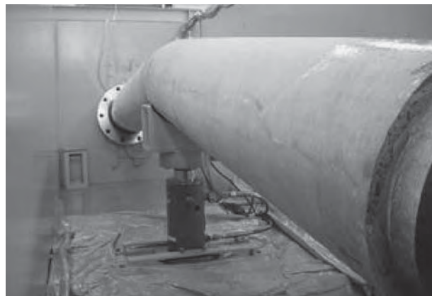
写真-3 継手部曲げ試験状況
