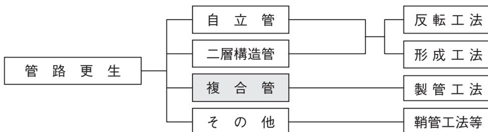
図-1 管路更生工法の分類
